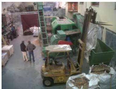
Foto 15. Alimentador, cinta y trituradora de una central de biomasa
