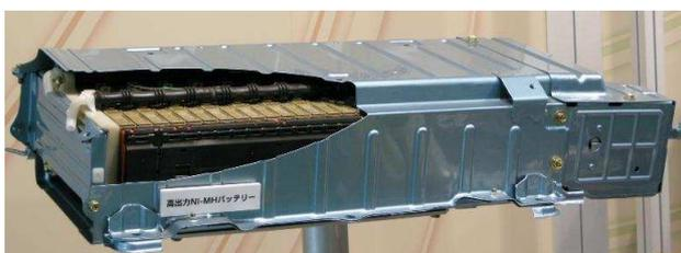
Batería Ni-MH de alta potencia. Fuente: Toyota
