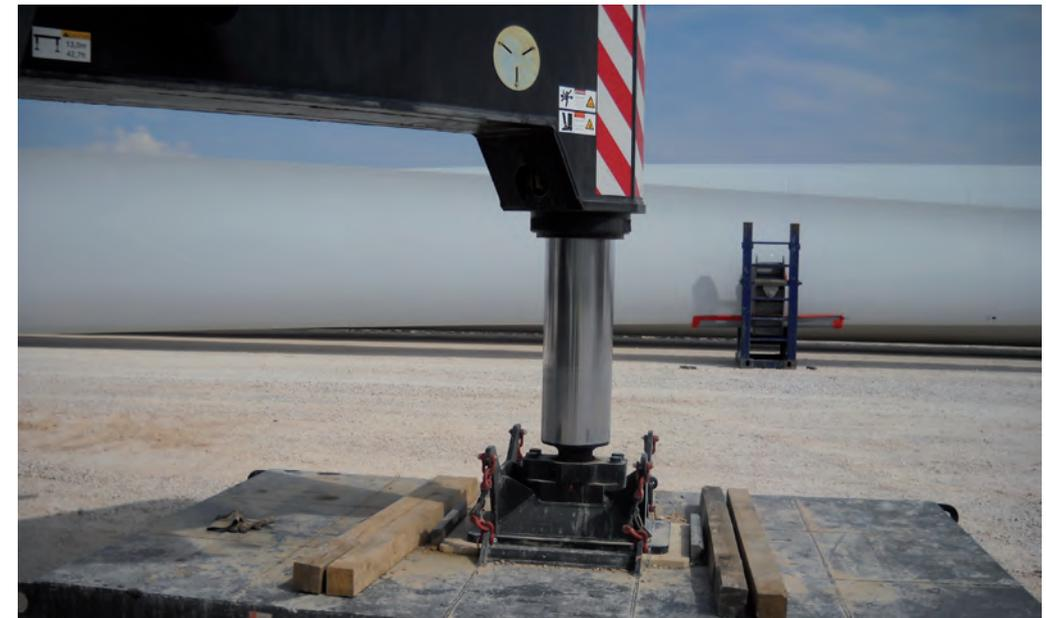
*"...primero se revisa la situación del entorno del trabajo, se comprueba que los suelos no tengan ninguna tara, como los suelos calizos que tienen una inconsistencia nula y forjados o posibles tuberías, túneles, zonas de alcantarillado, zonas huecas, una vez que sabemos seguro que no tenemos nada de esto, se emplaza la grúa en la posición de trabajo correcta, extensión de gatos, bajada de apoyos sobre madera para repartición de presión, pero lo 1º que hemos de ver es el suelo que tenemos..."*
